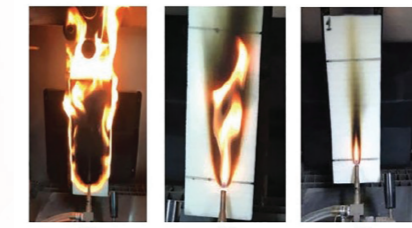
B3 ve B2 sınıfında PUR ürünlerin ve *B1 sınıfında PIR ürünün yanma testleri B3 and B2 class PUR products and *Flammability tests of PIR product in B1 class
